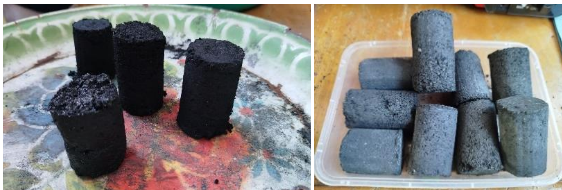
Gambar 4. Briket sebelum dikeringkan dan setelah dikeringkan
