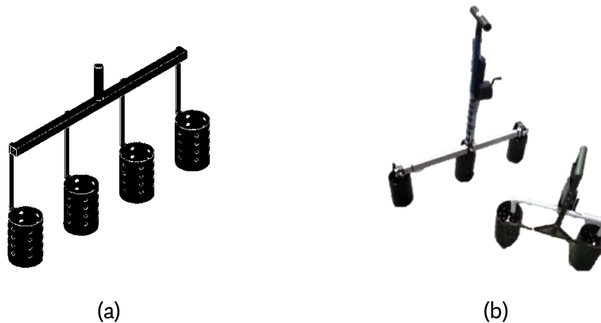
Gambar 2. Alat pelubang mulsa ganda (a) Rancangan (b) Prototipe
