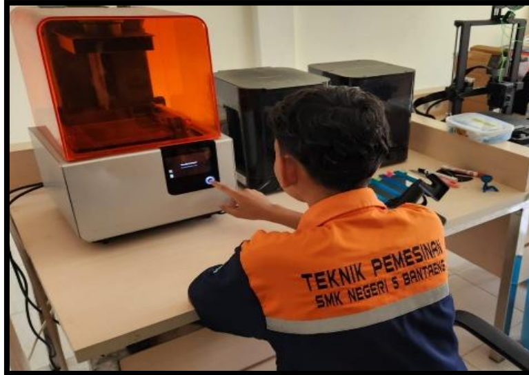
Gambar 6. Pencetakan Menggunakan SLA 3D Printer
