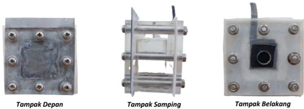
Gambar 2. Rangkaian Baterai Logam-Udara
