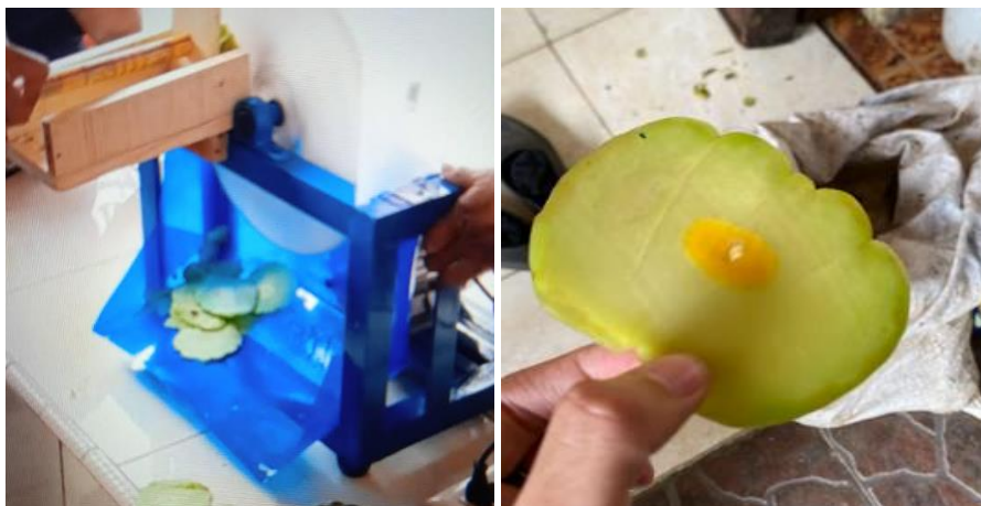
Gambar 8. Demonstrasi Uji Alat Potong dan Hasil Potongan Asam Gelugur
