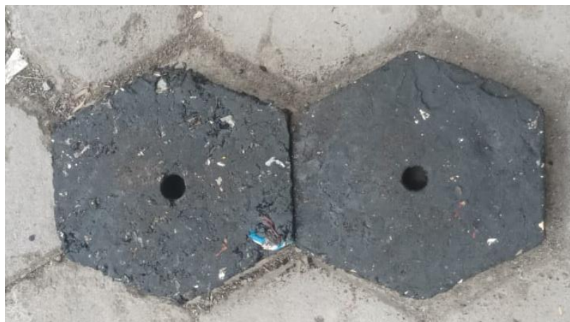
Gambar 4. Hasil campuran 20% oli dan 80% plastik setelah proses jemur kering.
