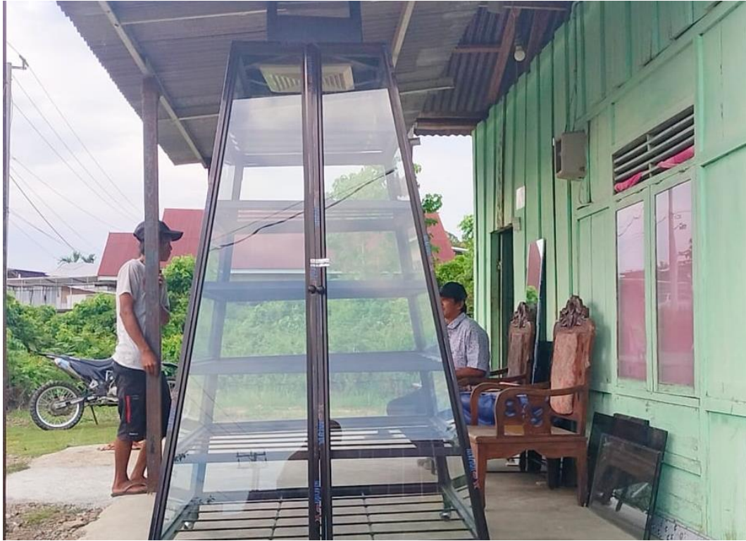
Gambar 6. Alat Pengering Ikan Kering Berbasis Efek Rumah Kaca
