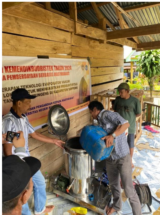
Gambar 5. Petani sedang menggunakan evaporator vakum dalam proses pemekatan nira aren
