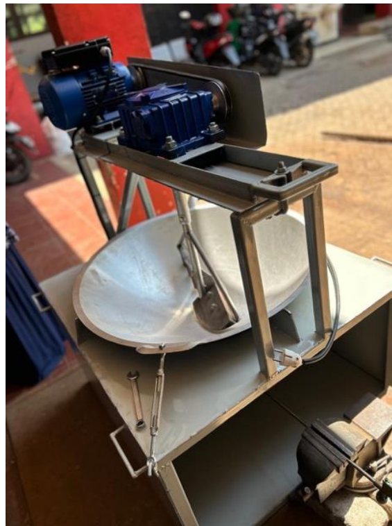
Gambar 2. Mesin kristalisator gula semut yang telah dimodifikasi
