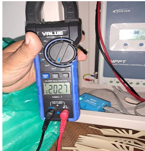
Gambar 2. Hasil Pengukuran Voltage PLTS yang mengalami drop Saat uji beban
